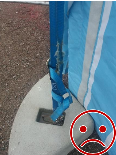
Kuormaliina on kulunut.
